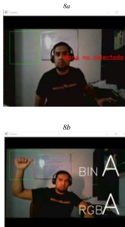
Figura 8: a) Detección de la ausencia de la mano, b) Detección de la mano y predicción de la letra por ambos modelos.
