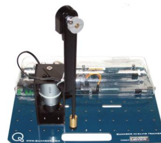
Fig. 3. Plataforma experimental ROTPEN de Quanser.
