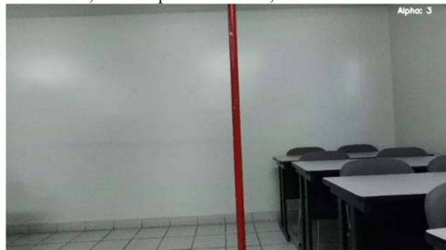
Fig. 5. Vista en primera persona del cuadricóptero frente a un lado del marco, sin ser capaz de detectarlo, llevando a una colisión.
