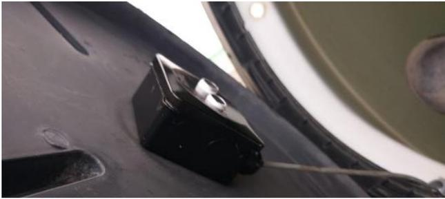
En la parte inferior del prototipo se observan los sensores utilizados para la recuperación de los datos. Esta información se procesa y permite generar las estadísticas y reportes que se muestran mediante las aplicaciones.
