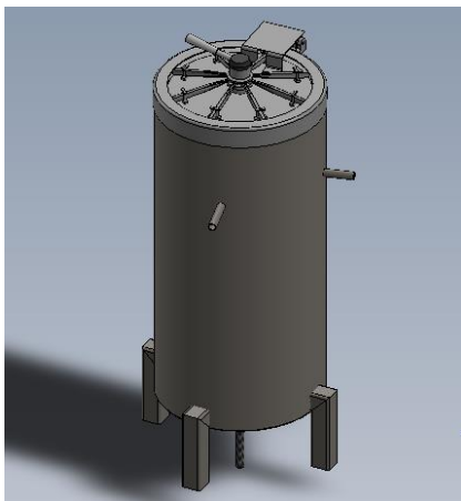
Figura 1. Representación gráfica de criocongelador elaborado mediante el software SOLIDWORKS®
