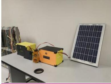
El actuador del sistema de control se compone de un motor a pasos y una válvula insertados en una base elaborada en un programa de diseño mecánico y fabricada en una impresora 3D, permite girar el vástago de la válvula de acuerdo al valor del centro de gravedad enviado por el controlador difuso, figura 9.
