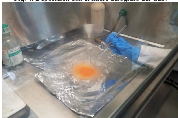
Fig. 4. Deposición con el micro aerógrafo del CdS.
