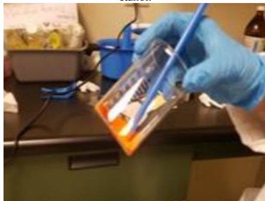
Fig. 3. Solución homogénea de 50% CdS, 40% etilenglicol y 10% etanol.
