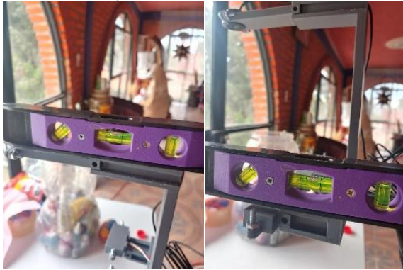
Fig. 4. Nivelación de sensores.
