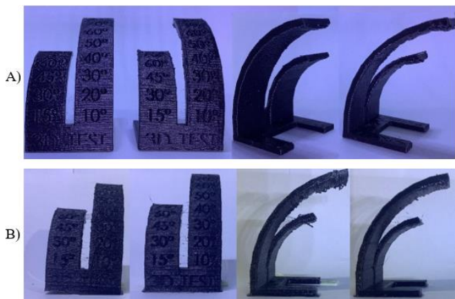
Fig. 11 Parámetro ventilación de capa.
