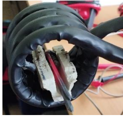
Fig. 17 Clavos expuestos a inducción electromagnética
