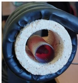
Fig. 18 Tubo de metal ferroso expuesto a inducción electromagnética
