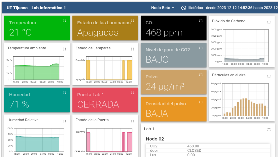
Fig. 12. Panel del Laboratorio 1, mediciones hechas por el Nodo Beta.
