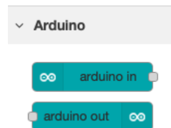
Figura 9 Nodos de NodeRED de acceso con firmata a unatarjeta de conversión analógica/digital de adquisición de datos
