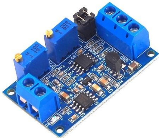
Figura 7 Convertidor industrial de corriente a voltaje, que con un circuito adicional de calibración, sirve para la lectura de sensores de corriente.
