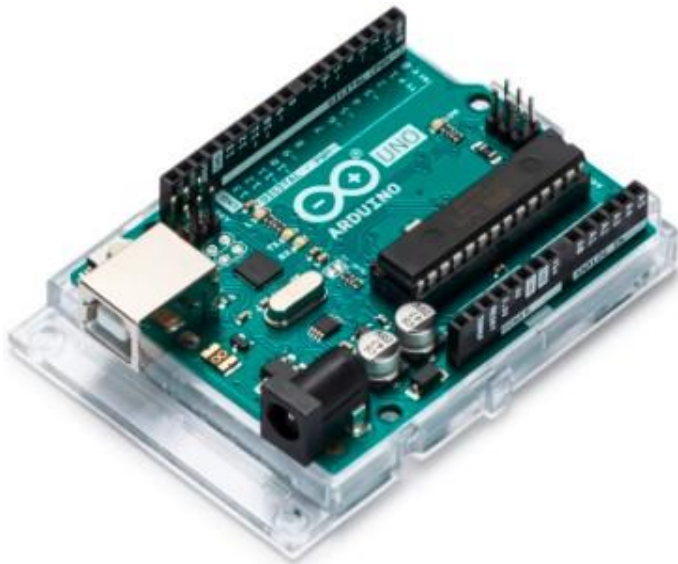
Figura 10 Tarjeta de electrónica abierta arduino UNO básica para la conversión analógico/digital.
