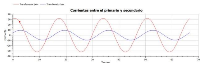
Figura 10 Relación de corrientes en el primario y secundario resultantes, en donde la distorsión mínima, dado que no se agrega el efecto de la histéresis.
