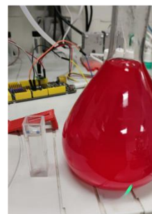
Figura 4. Degradación de colorante tipo "azo" en fotorreactor
