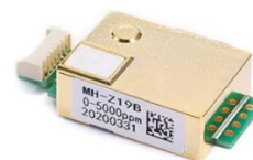
Fig. 3. Sensor de \text{CO}_2 conocido como el MH-Z19B .
