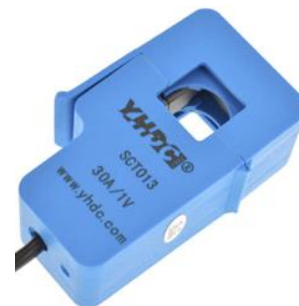
Figura 7 Convertidor industrial de corriente de no contacto a voltaje, que, con un circuito adicional de calibración, sirve para la lectura de sensores de corriente.
