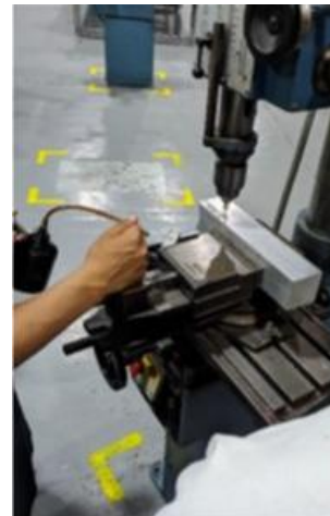
Fig. 5. Manufactura en fresadora vertical.
