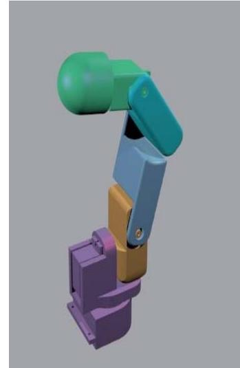
Fig.6 Robot de cuatro grados de libertad.
